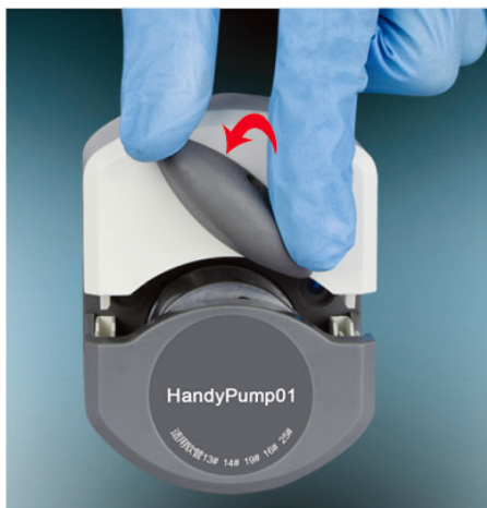
1. 逆时针扳动旋钮 180°, 打开压块。
